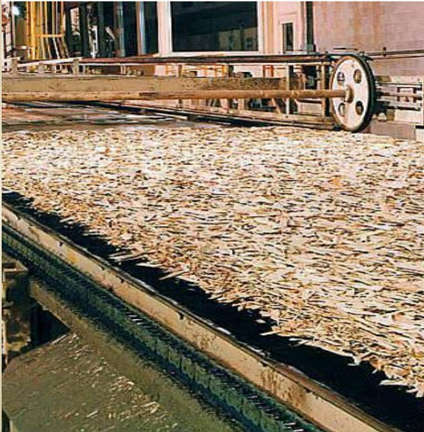
Los listones entonces se colocan por capas sobre un tapete movable. La dirección de la longitud de los listones de las capas inferior y superior sigue en gran parte la dirección de la longitud del panel.
