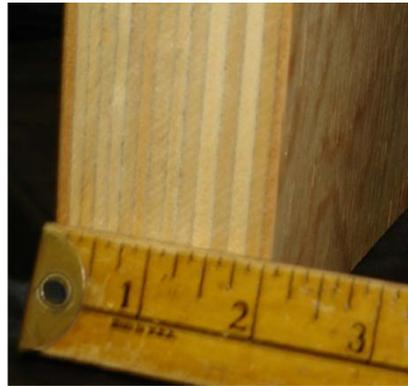
Los Paneles se pueden fabricar en muchos y distintos tamaños. La madera contrachapada se puede fabricar en grosores de 2-1/2" (63.5 mm) o más.
