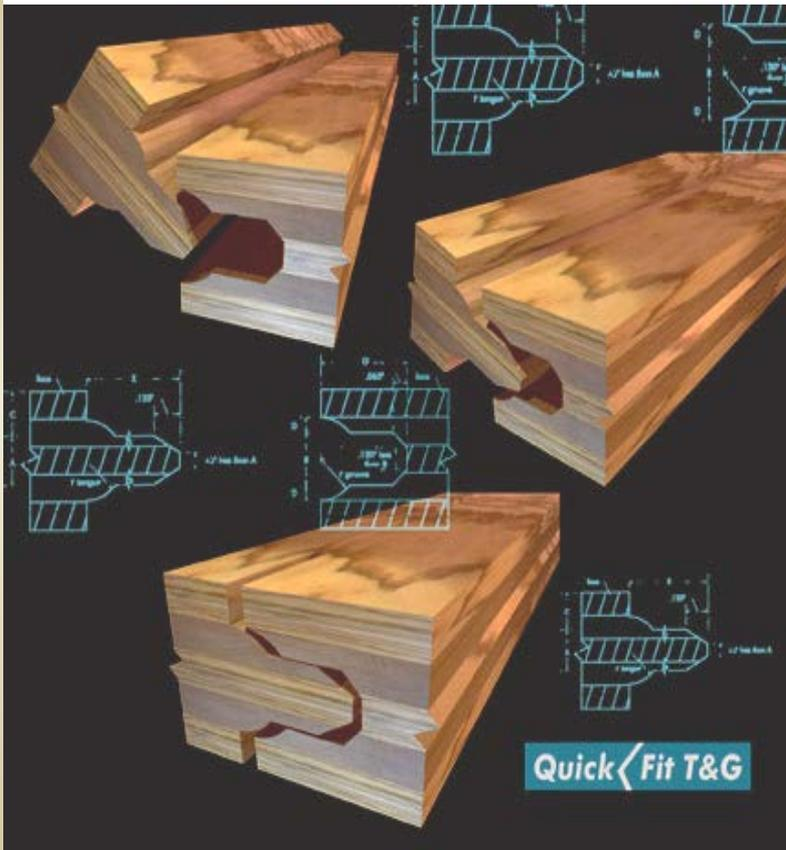
Muchos Paneles están disponibles con juntas tipo machihembrado en los bordes largos y esto es mucho más que una característica estándar. La junta T&G (tipo machihembrado) sostiene los bordes y de esta forma las cargas se transfieren de un panel al panel adyacente.
