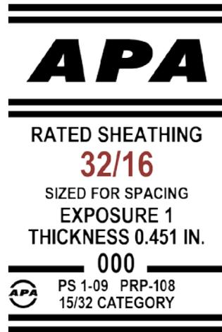
La mayoría de las marcas registradas que aparecen en los paneles de Clasificación de Alta Calidad de la APA utilizan uno o dos dígitos para indicar la resistencia del panel, la cual se conoce como ‘Clasificación de Tramo’ del panel. Entre más altos sean los números, más resistente es el panel.
