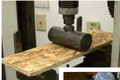
Tanto el fabricante como la APA realizan pruebas a los paneles para garantizar el nivel de alta calidad representado en la marca registrada.
