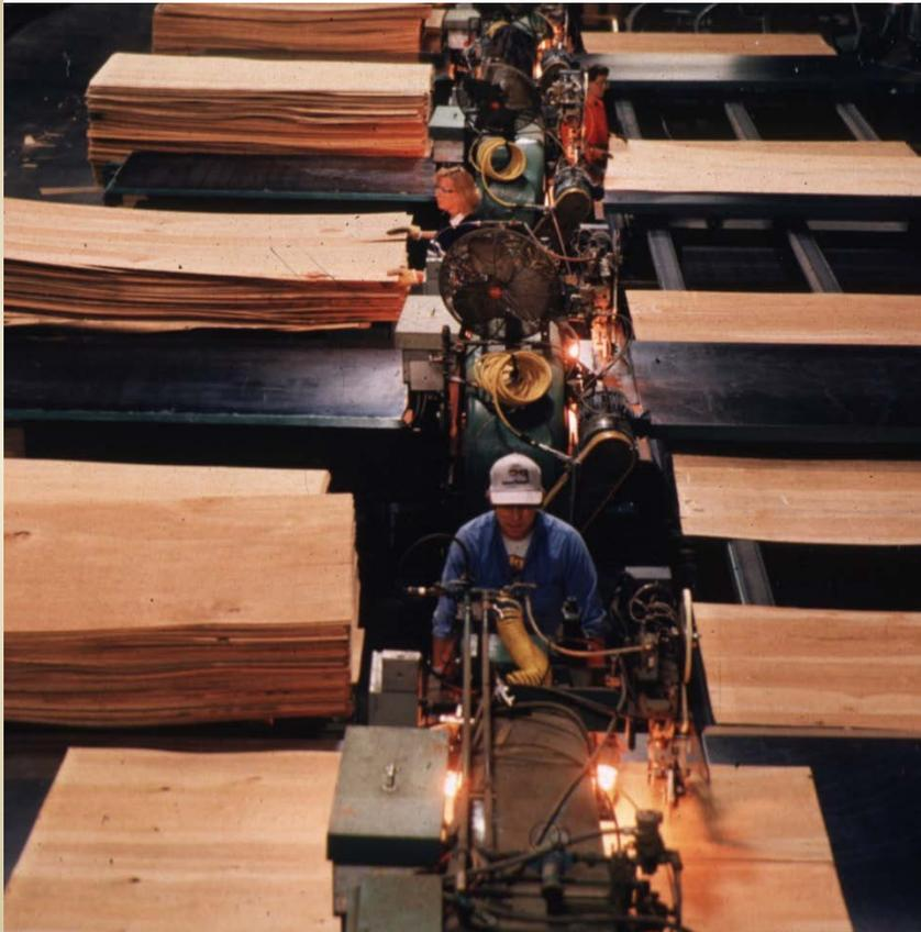
Las chapas que se van a utilizar en las caras de madera contrachapada de clasificación alta se mejoran eliminando los defectos y reemplazando dichas áreas con parches de madera sólida y rellenos sintéticos.
