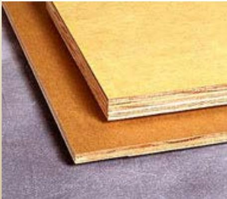
Existen dos tipos de revestimientos de papel saturado de resina: Revestimientos de Densidad Media (MDO) y Revestimientos de Alta Densidad (HDO). Los revestimientos tipo HDO tienen un mayor contenido de resina haciendo que la superficie sea más impermeable y dura.
