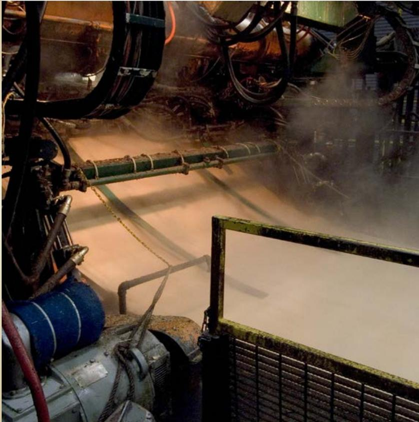
La chapa se seca hasta obtener un contenido de humedad bajo para facilitar el proceso de pegado.
