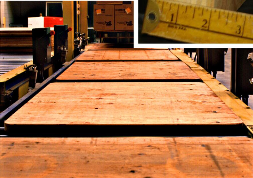
Una aplicación común para los paneles gruesos es la de pallets esclavos que generalmente soportan pallets cargados en los sistemas de recuperación y almacenamiento automatizado.
