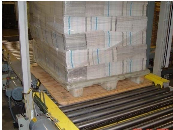
**Este tipo de aplicación se debe evaluar minuciosamente para asegurarse que la chapa de superficie puede resistir el desgaste y las cargas que ocasionan las fuerzas de compresión y desgaste.**
