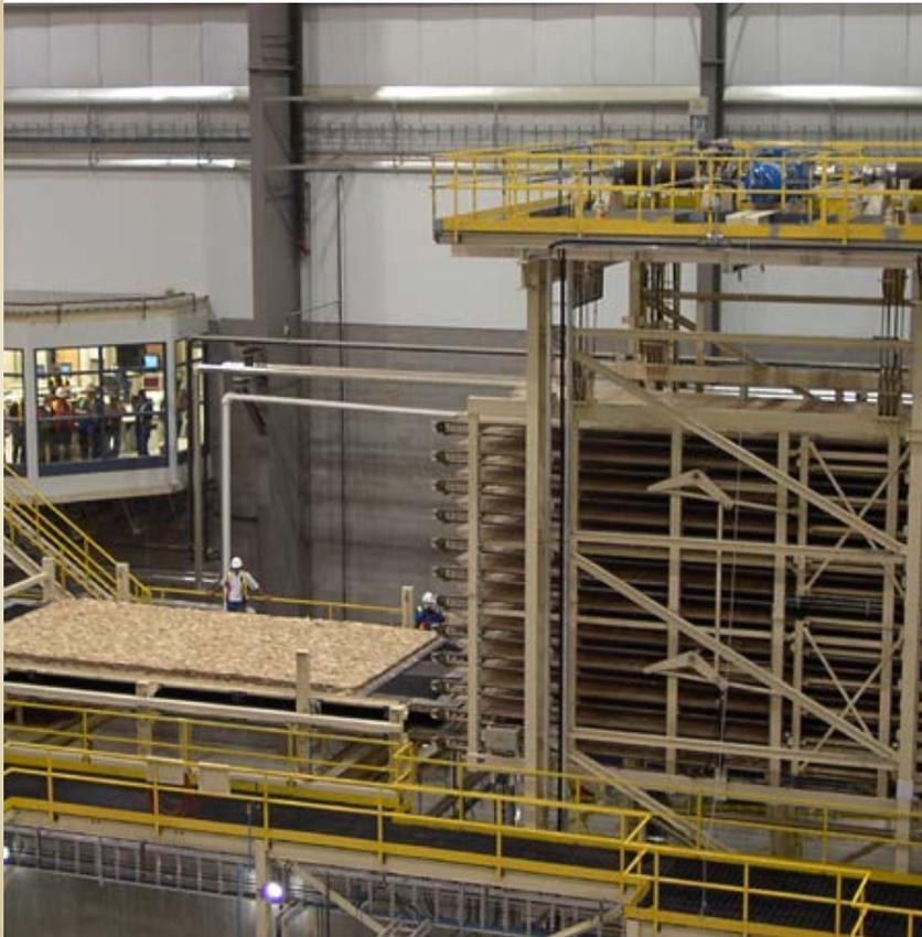
Posteriormente, el tapete de listones se coloca en una prensa en donde las resinas que unen el panel se activan por medio del calor y la presión.
