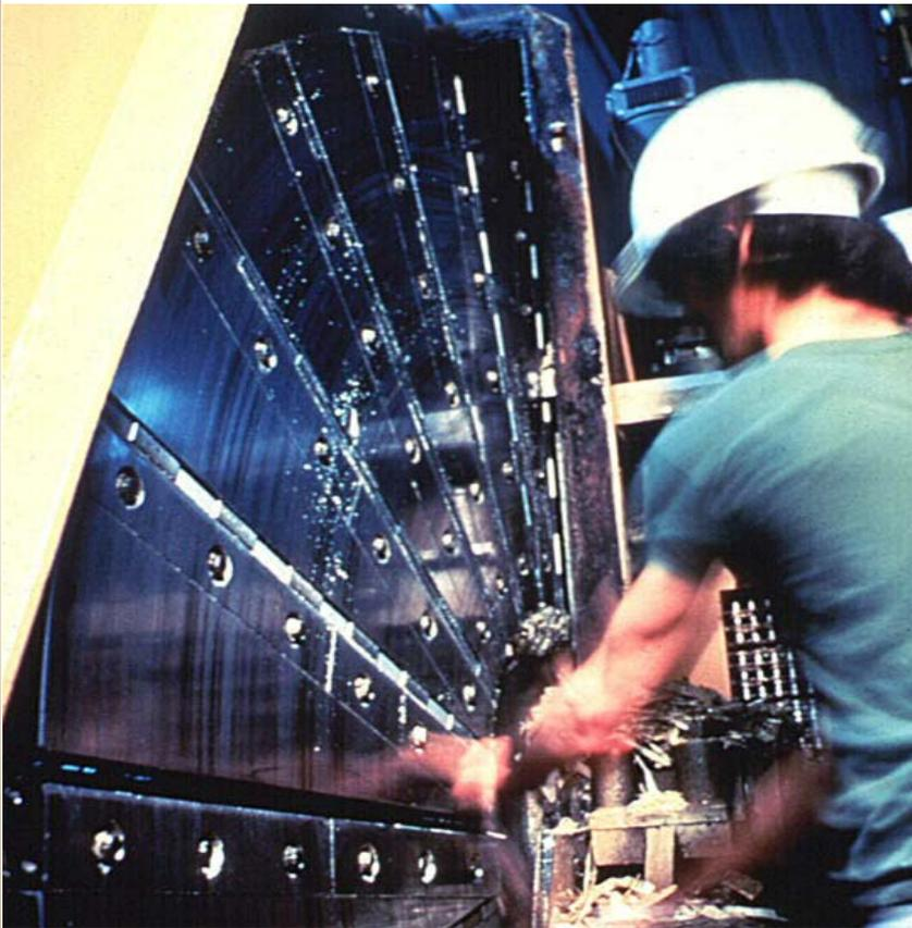
En la fabricación de las Tablas de Filamento Orientado (OSB) se utiliza equipo que corta los troncos en tiras de madera.
