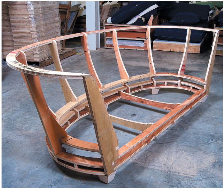
La madera de ingeniería produce un alto rendimiento ya que todas las partes de este marco se cortan de una sola hoja de triplay de 4x8 pies.
